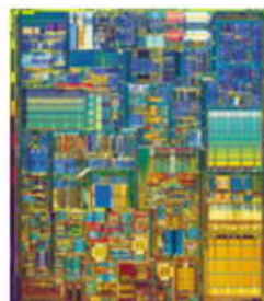
El Pentium IV de Intel, creado en el año 2000, contiene unos 10 millones de transistores.
