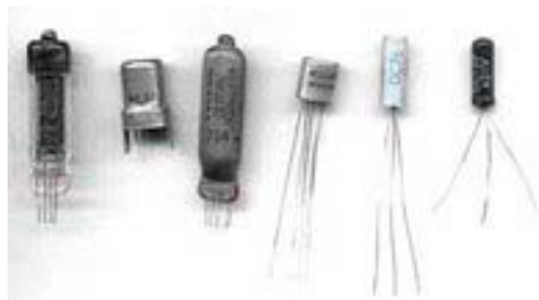
Comparación entre las válvulas y antiguos transistores individuales de germanio
